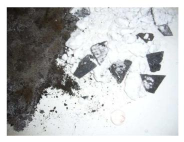
Das zweite Bild zeigt auf der rechten Seite auf ca. 3 cm vorzerkleinerte Materialstücke, die mit Trockeneis gemischt wurden und im linken Teil das durchgesetzte Material. Dabei wurden die fasrigen Bestandteile gezielt aussortiert ins Bild gesetzt.
