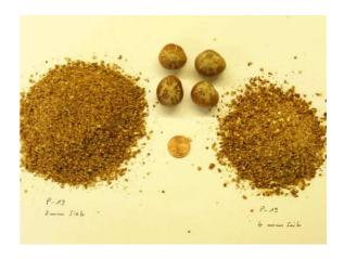
Durchgeführt wurden mit Haselnüssen und Walnüssen zudem auch Tests mit einer 2 mm Siebkassette. Für Haselnüsse ist dies ein gangbarer Weg. Für kleinere Mengen Walnüsse ist dies auch zu empfehlen. Da die erzeugten Proben in den folgenden Schritten weiter aufbereitet werden, ist die Verwendung der 4 mm Siebkassette in der Universal-Schneidmühle als optimale Lösung zu empfehlen.
