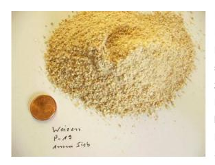
Die erwähnte Norm beschäftigt sich auch mit der Probenahme von Getreide, Gewürzen und Kaffee. Mit der Schneidmühle PULVERISETTE 19 lassen sich auch größere Mengen dieser Proben zerkleinern. Dies wird im nebenstehenden Bild am Beispiel von Weizenkörnern gezeigt. Für die Aufbereitung kleinerer Probemengen (< 100ml) dieser Materialien eignet sich auch sehr gut die Rotor-Schnellmühle PULVERISETTE 14.
