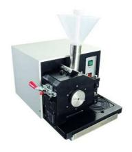
Bei der Zerkleinerung von Nüssen mit Schale kommt es aber neben einem guten Zerkleinerungsergebnis insbesondere auf die Reinigung in vertretbarer Zeit an. Die Zerkleinerung von Erdnüssen ist wohl die einfachste und unproblematischste Aufgabenstellung. Genutzt wurde die Universal-Schneidmühle mit einer 4 mm Siebkassette, dem Lang- und Schüttguttrichter und dem Standard-Rotor aus Stahl mit V-Schneidgeometrie.
