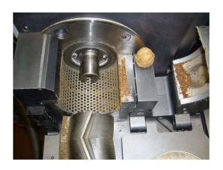
Auch ein anschließender Blick in die geöffnete Schneidmühle zeigte, dass sich die Walnüsse sehr gut durchsetzen lassen. Das Sieb war frei. Weiteres Material hätte durchgesetzt werden können. Der Rotor wurde von der Motorwelle ohne Werkzeug abgezogen und vor dem Sieb platziert. Die Siebkassette ist ebenfalls ohne Werkzeug zu entnehmen. Damit sind alle zu reinigenden Teile sehr gut zugänglich.
