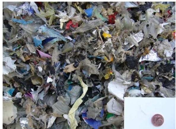
Allen gemeinsam ist, dass sie energetisch interessante Beimischungen bei thermischen Prozessen sind. Wichtigster Parameter ist damit der Heizwert (bestimmt nach DIN 51900 „Prüfung fester und flüssiger Brennstoffe“ und „Bestimmung des Brennwertes“).
