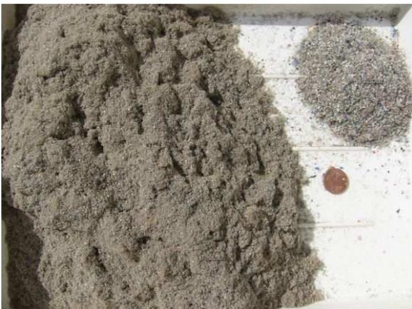
Hier wurde der nicht zerkleinerte Rest ausgekehrt und liegt neben der Probe, die das Sieb passiert hat.
