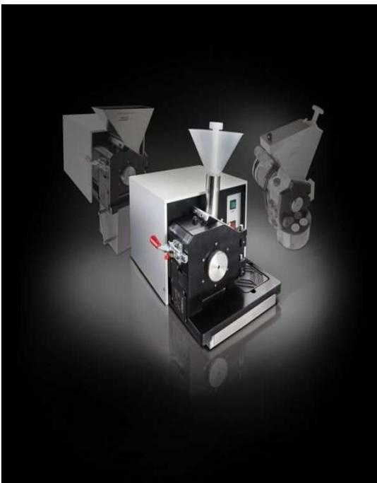
Wird ein Siebdurchgang von 0,5 mm gewünscht, sind die meisten Materialien nur durch Kombination der Schneidmühle mit dem Zyklon aufzubereiten. Der Zyklon erzeugt einen Luftstrom. Dieser saugt die Materialien am Einfülltrichter regelrecht an, wirkt bei der Mahlung kühlend und fördert den Mahlstrom und damit das Passieren des Siebes. Die fertig aufbereitete Probe wird durch den Zyklon in einem Probenglas abgeschieden.
