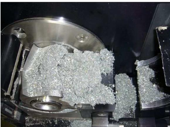
Nach der Aufbereitung darf im Mahlraum der Schneidmühle nur wenig Material zurück bleiben. Keinesfalls darf es so aussehen.
