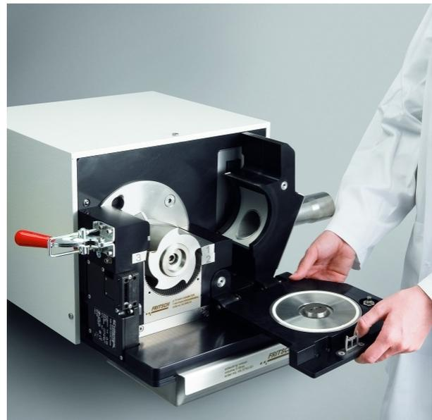
Der Vorteil dieses Systems ist die einfache Handhabung während des Reinigens und des Schneidwerkzeugwechsels.
