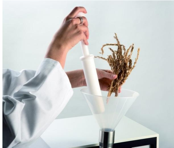
Zur Zerkleinerung der pflanzlichen Reststoffe werden dann in vielen Technikums- und Pilotanlagen Schneidmühlen aus dem Hause Fritsch eingesetzt. Hier speziell die [Universal Schneidmühle PULVERISETTE 19](#) in Kombination mit der Probenabsaugung (Zyklon).
