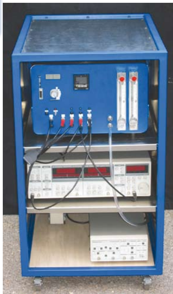
Abbildung 3: Optoakustisches System zur Rußmessung in motorischem Abgas.
